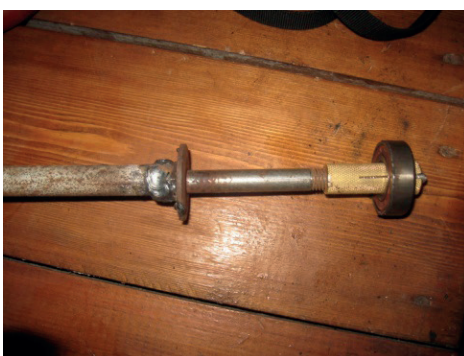
Извлеченный подшипник на гильзе обратного молотка
