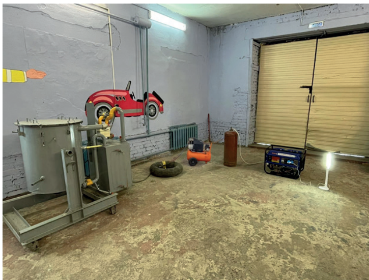
Рисунок 4. Проверка автономной когенерационной линии на пиролизной технологии
