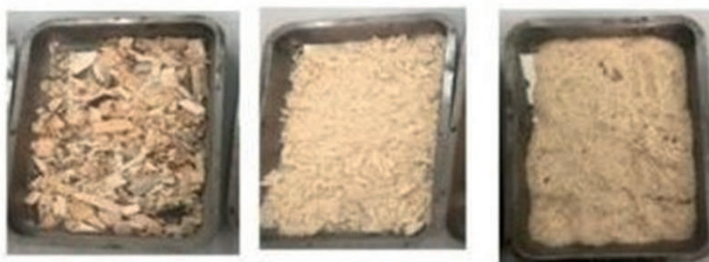
Рисунок 2 – Виды древесных отходов: а) щепа; б) опилка; в) пылевидная опилка
