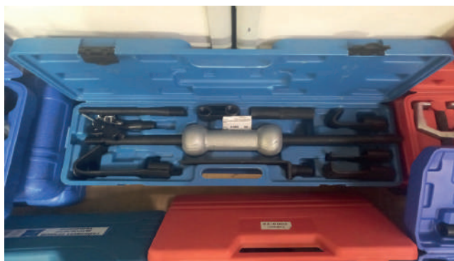
Молоток обратный для кузовных работ «МАРКАВТО» 4000 Цена 5900,00 руб.
