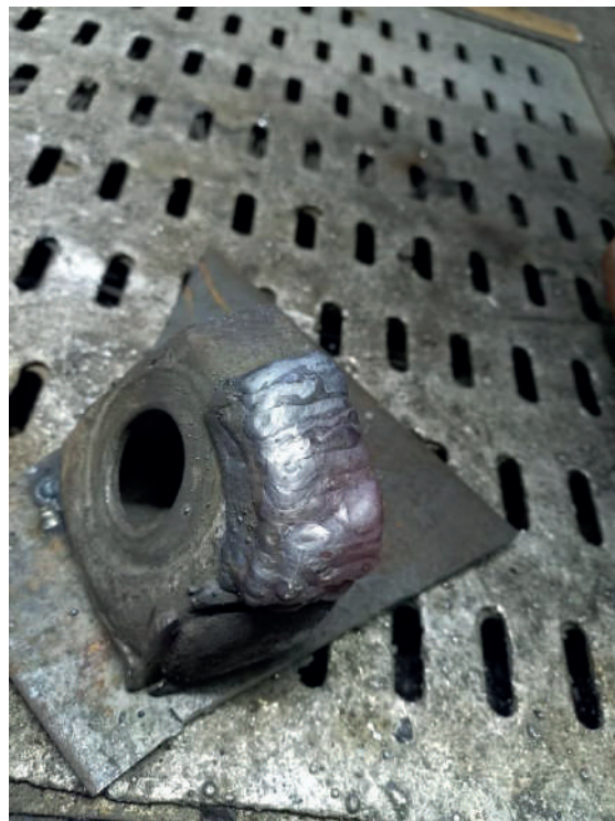
Результат восстановительной наплавки коронки ковша экскаватора
