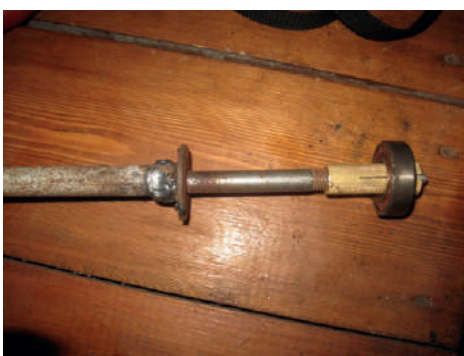
Извлеченный подшипник на гильзе обратного молотка
